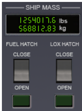
Indicador de Masa de la Nave e Interruptores de escotillas para Recarga de Combustible y LOX
