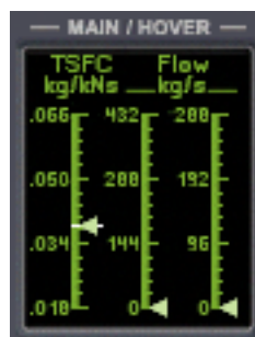
PRINCIPAL/SUSTENTACIÓN TSFC e instrumento de consumo de combustible en el panel inferior
