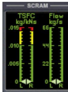
SCRAM TSFC e instrumento de flujo de combustible en el panel principal
