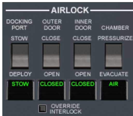
Controles de la Cámara de Presurización y Escotillas del Panel Superior.
